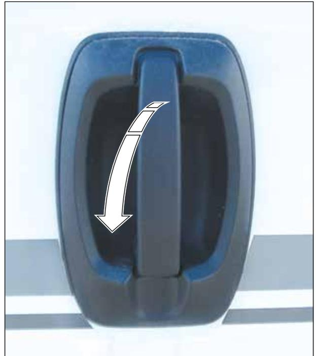
Abb. 7 Schiebetür von außen öffnen und schließen
