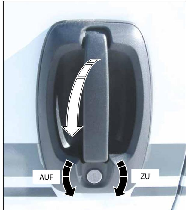
Abb. 5 Fahrerkabinentür von außen öffnen und schließen
