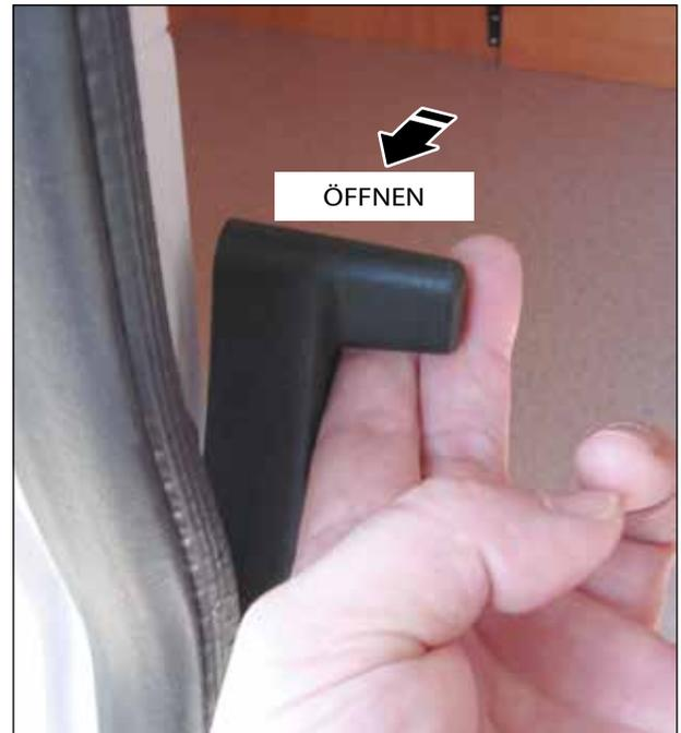
Abb. 11 Zweiten Flügel der Zweiflügel-Hecktür von innen öffnen und schließen
