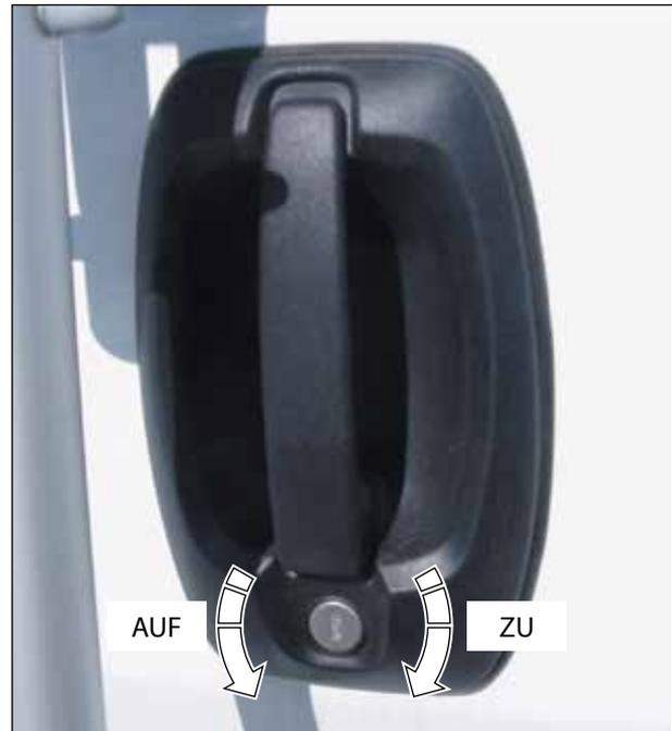
Abb. 9 Ersten Flügel der Zweiflügel-Hecktür von außen öffnen und schließen
